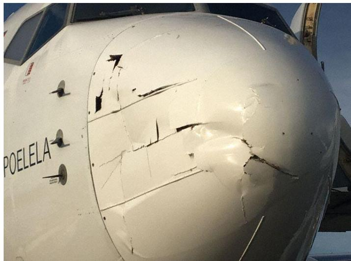
Fotografia dos danos causados, por colisão com um *drone*, num Boeing 737-700 das Linhas Aéreas de Moçambique, dia 5 de janeiro
