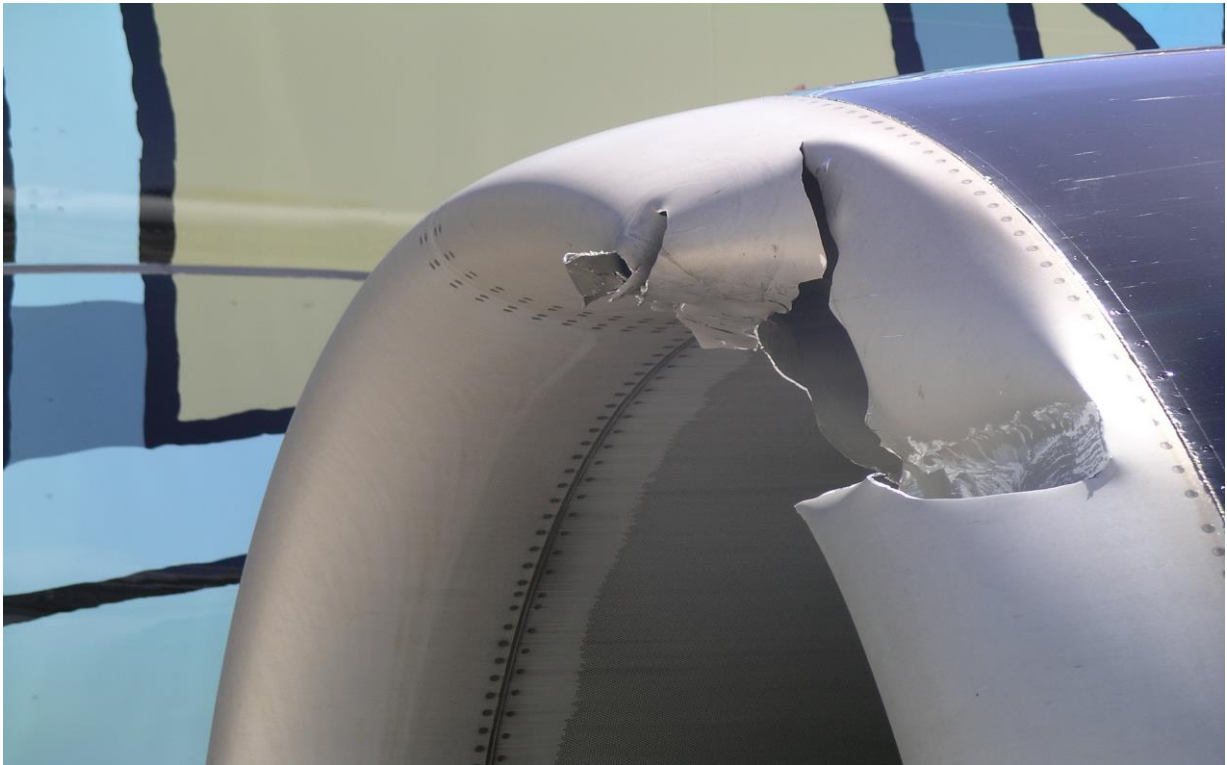
Figura 6 - Vista lateral da zona danificada da carenagem da entrada de ar motor esquerdo || Figure 6 - Side view to the damaged area of the left engine air inlet cowl
