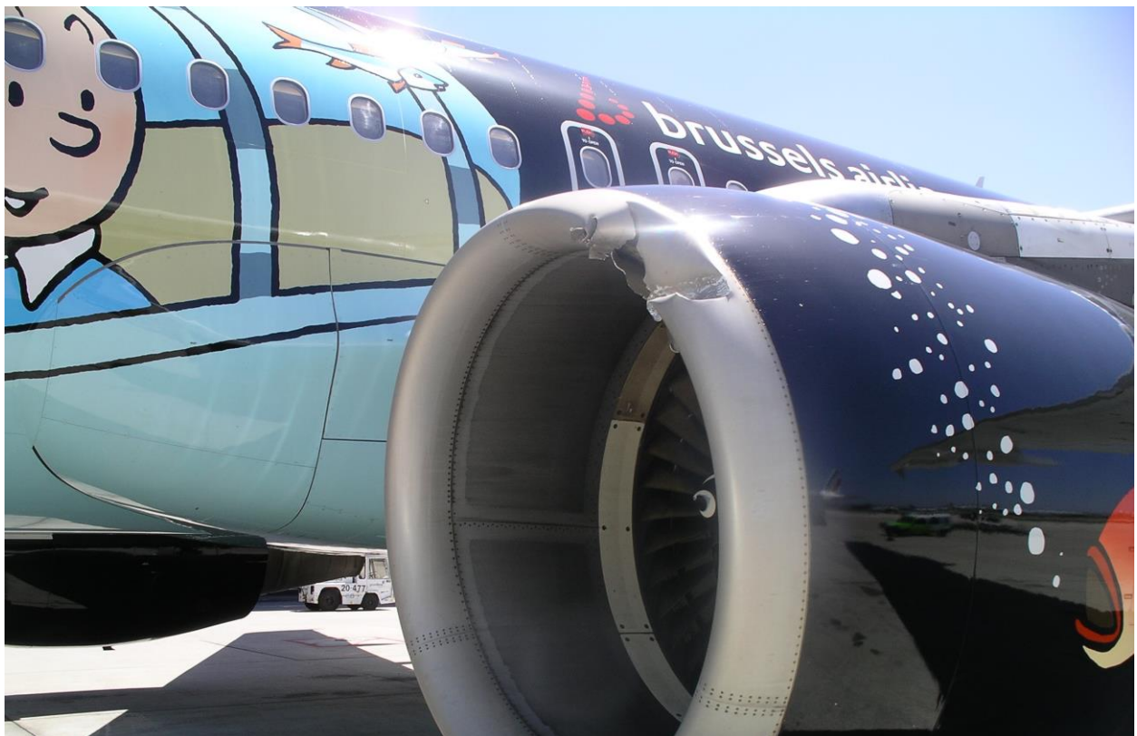
Figura 5 - Rasgo na carenagem da entrada de ar motor esquerdo || Figure 5 - Damage to the left engine air inlet cowl
