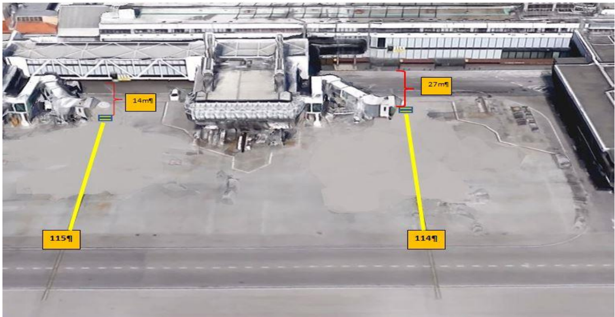
Figura 31 - Imagem frontal com o desenho da posição 114 e dimensões || Figure 31 - Frontal image with position 114 layout and dimensions
