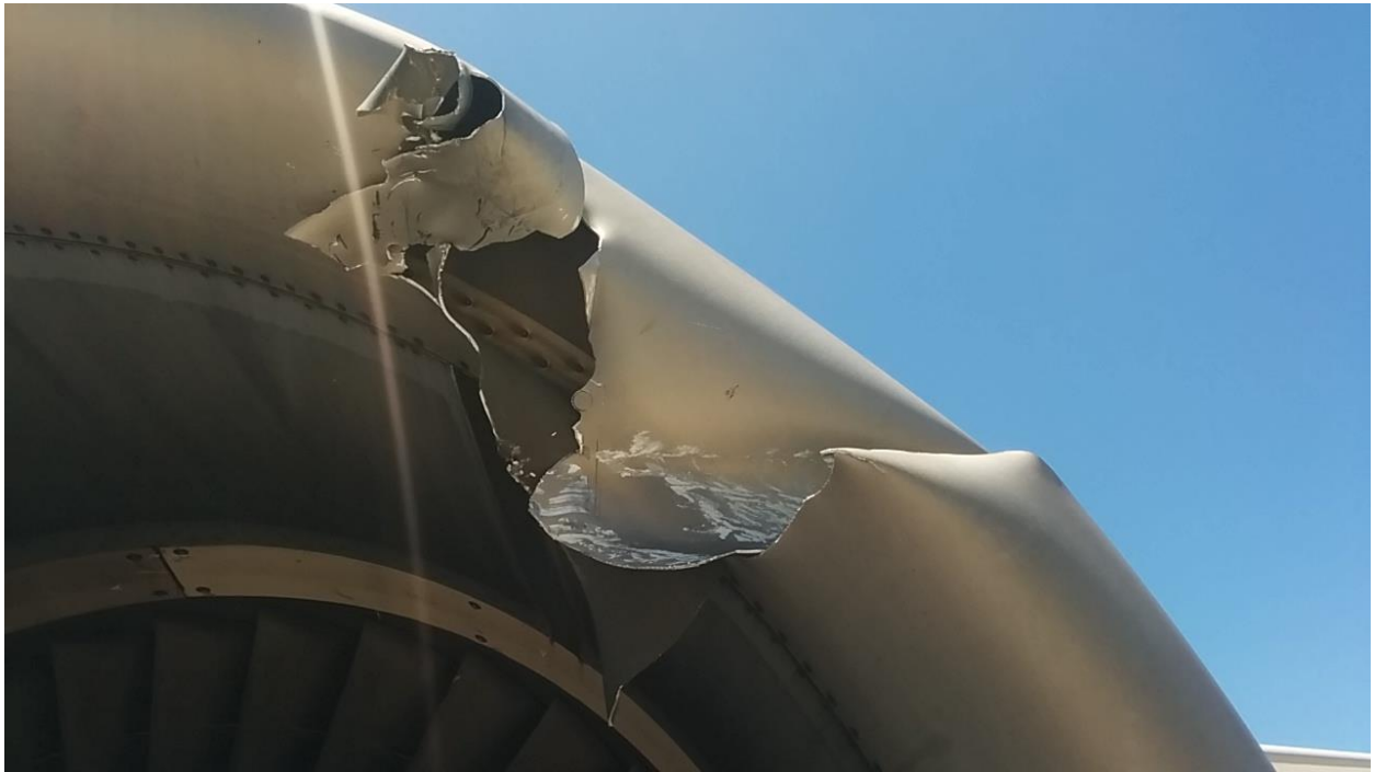
Figura 4 - Dano na carenagem da entrada de ar motor esquerdo || Figure 4 - Damage to the left engine air intake cowl
