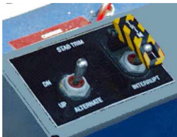
Figura 14 || Figure 14 Interruptor alternativo do compensador do estabilizador à esquerda e interruptor de paragem à direita || Stabilizer trim alternate switch on the left and interrupt switch on the right
