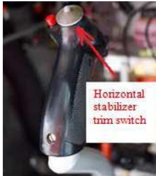
Figura 13 || Figure 13 Imagem de um interruptor semelhante || Picture of a similar stabilizer trim switch
