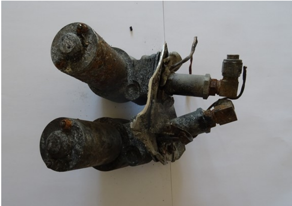
Figura 15 || Figure 15 Bombas de combustível || Fuel boost pumps
