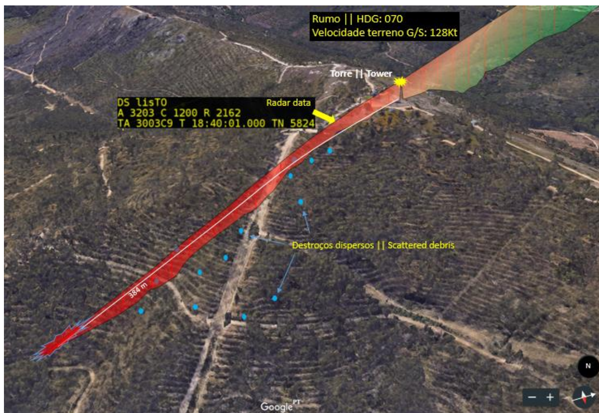
Figura 2 || Figure 2 Ilustração da trajetória pós impacto com a torre || Post impact trajectory illustration with the tower
