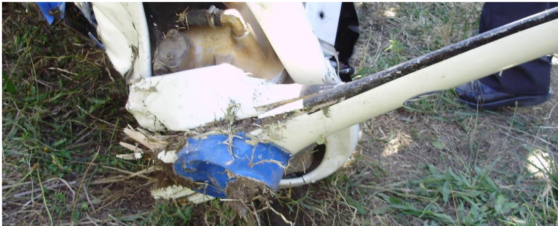
Figura 7 || Figure 7 Estado das pás da hélice || Propeller blades condition
