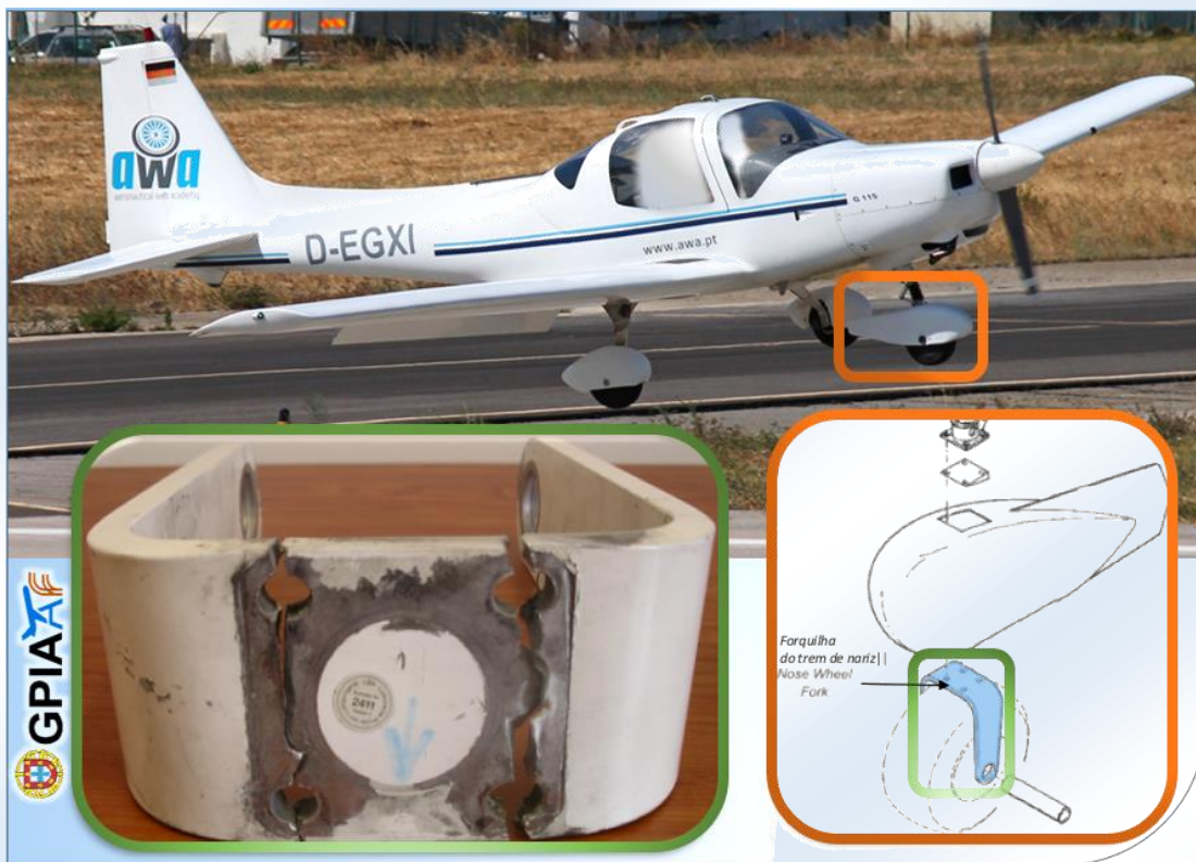
Figura 3 || Detalhe do componente no trem de aterragem e danos (Fotografia da aeronave na aterragem por Diogo Guimarães)
