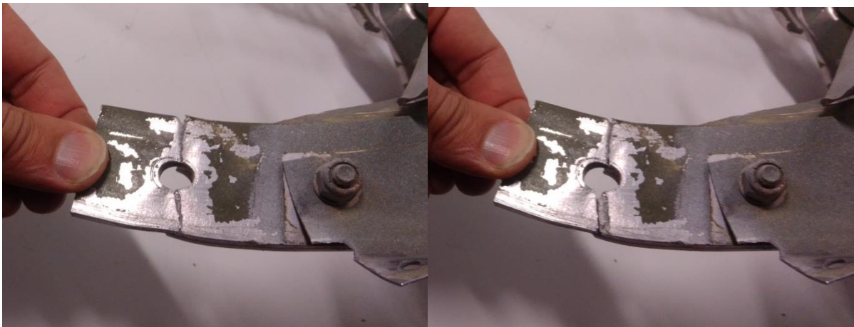
Figura B – Detalhe da zona fraturada da mesa inferior traseira da longarina (vista de trás).
