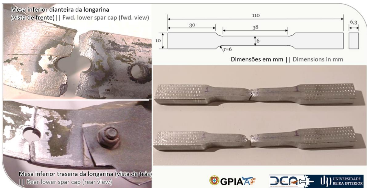
Figura 10 || Figure 10 Provette e detalhe da zona fraturada || Specimen and fracture detail
