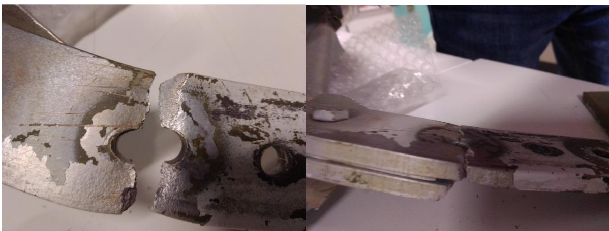
Figura C – Detalhe da zona fraturada da mesa inferior dianteira da longarina (vista de frente e de baixo).
