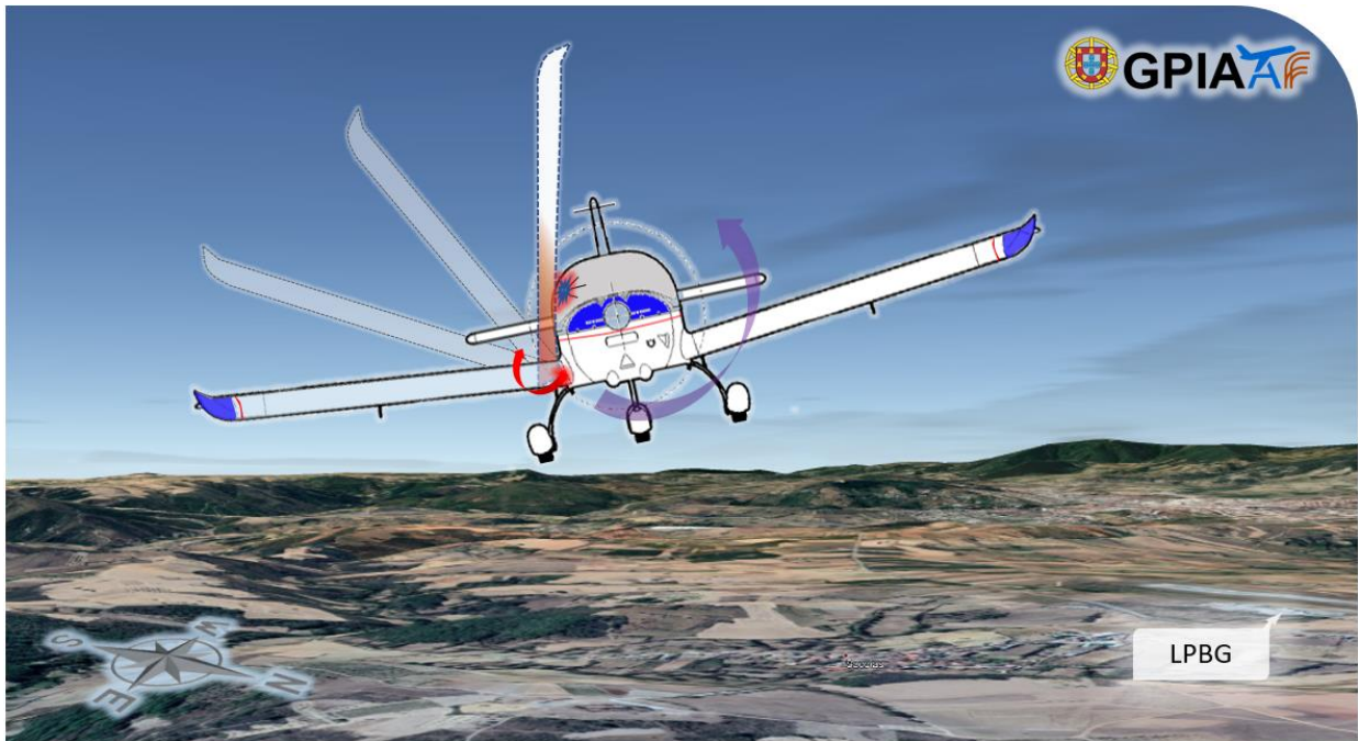
Figura 2 || Figure 2 Sequência de falha da semi-asa direita da aeronave || Failure sequence of RH aircraft semi-wing
