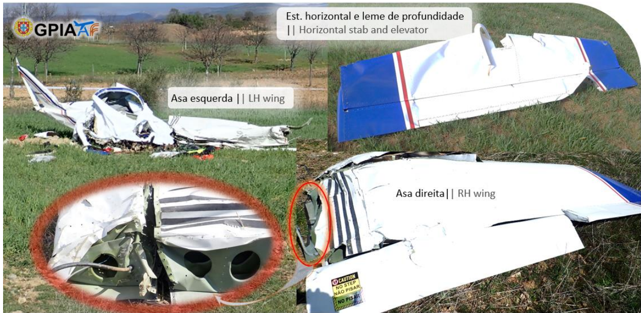
Figura 9 || Figure 9 Detalhe dos principais destroços || Main wreckage detail
