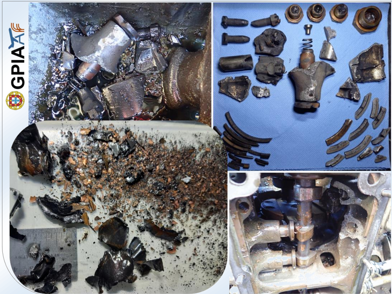
Figura 3 || Detritos metálicos encontrados no cárter do motor
