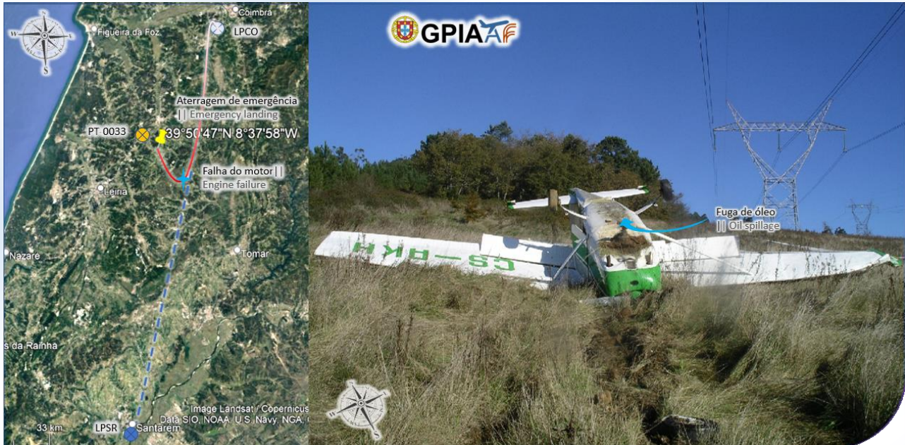
Figura 1 || Figure 1 Trajetória estimada e posição final da aeronave || Estimated trajectory and aircraft final position
