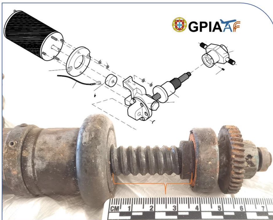
Figura 5 || Figure 5 Atuador dos flaps || Flaps actuator
