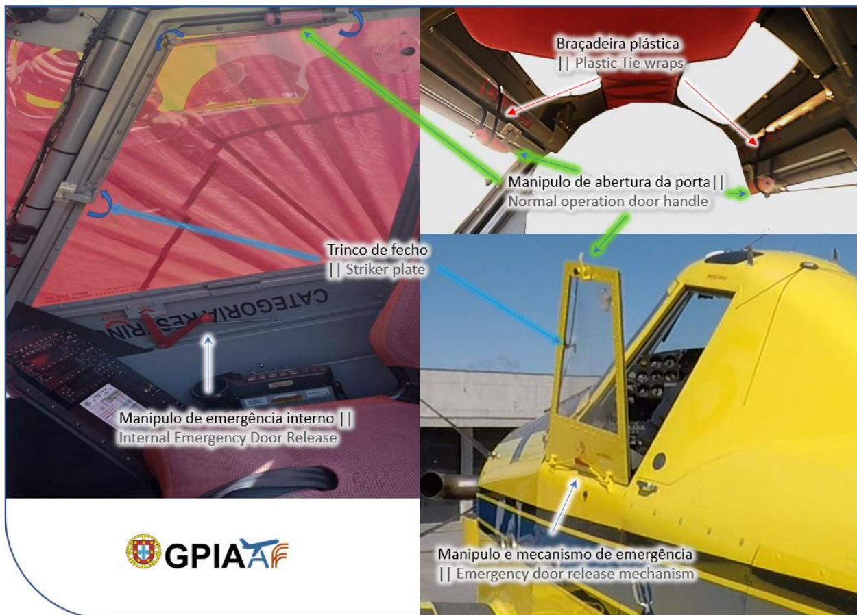
Figura 7 || Figure 7 Detalhe das portas/saídas de emergência da aeronave || Aircraft door and emergency exit details
