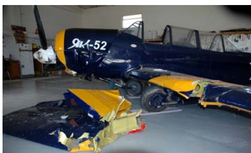
Foto N°2. Danos do lado esquerdo
